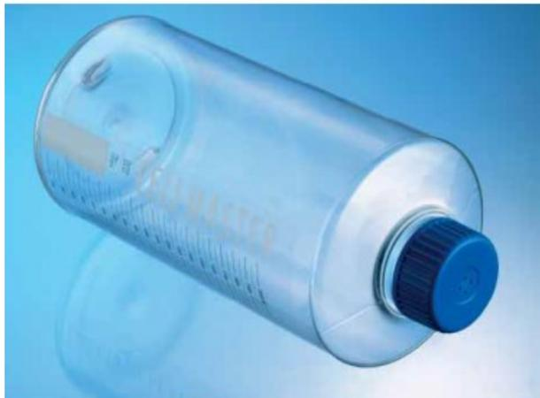
Flaconi per coltrure CELLMASTER ROLLER GREINER in PS e tappo con filtro 122,0X271 mm, forma liscia area sup. 850 cm<sup>2</sup> cf 2 imballo 24 pz
