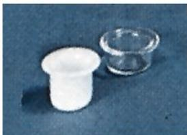
Capsula per bomba di Mahler in quarzo trasparente con bordi  $\varnothing$ xH 22X20 mm
