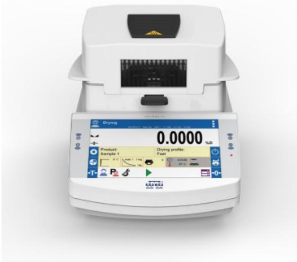
Analizzatore di umidità 210 g, precisione 1 mg, lampada infrarossi a 160°C
