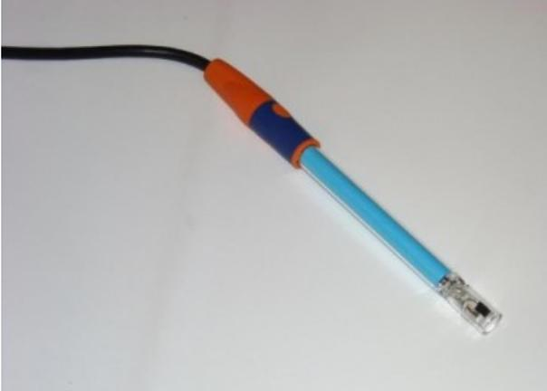
Cella in vetro platino C=1, cavo fisso 1 m con BNC, campo  $10\mu\text{s} \div 10 \text{ mS}$ .
