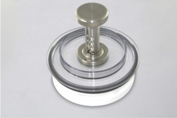
Coperchio gravimetrico in plastica, con canali di fuoriuscita, autoclavabile e resistente ai graffi.
